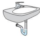
下水道存水管
